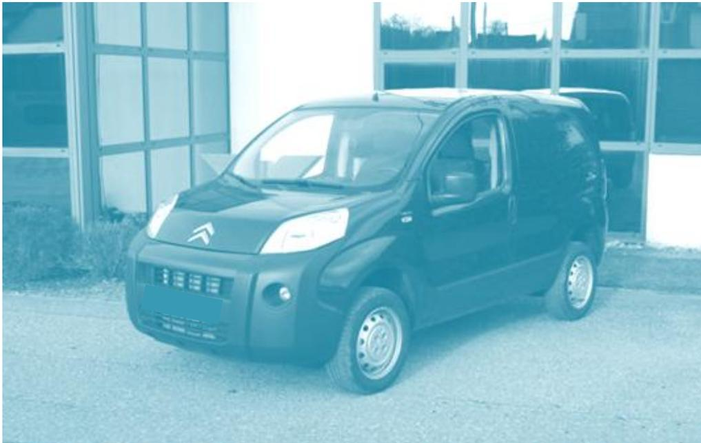
**Mobile et Rassurant** : Fort de ses **20** cm de garde au sol, le Nemo TREK efface les difficultés du terrain. Ses atouts : un écran de protection sous moteur, un différentiel à glissement limité (en option) qui assure un couple moteur sur la roue ayant la plus forte adhérence. Efficace sur toutes surfaces, le système repousse plus loin les pertes d'adhérence et vous offre une sécurité et une mobilité étonnante pour un véhicule 2 roues motrices.
