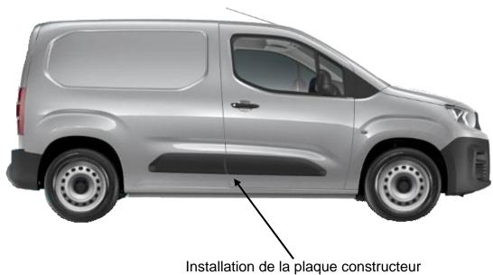
Installation de la plaque constructeur sur le pied milieu côté droit.
